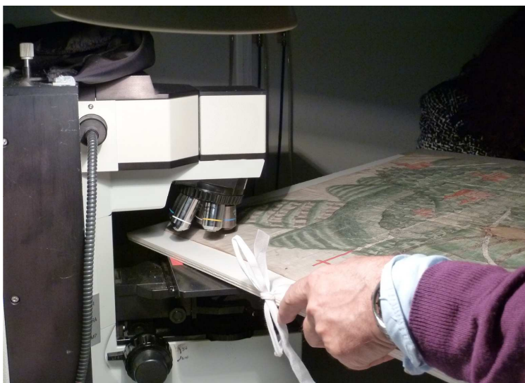
Fig. 24. Il microscopio Raman durante l'esecuzione delle analisi
